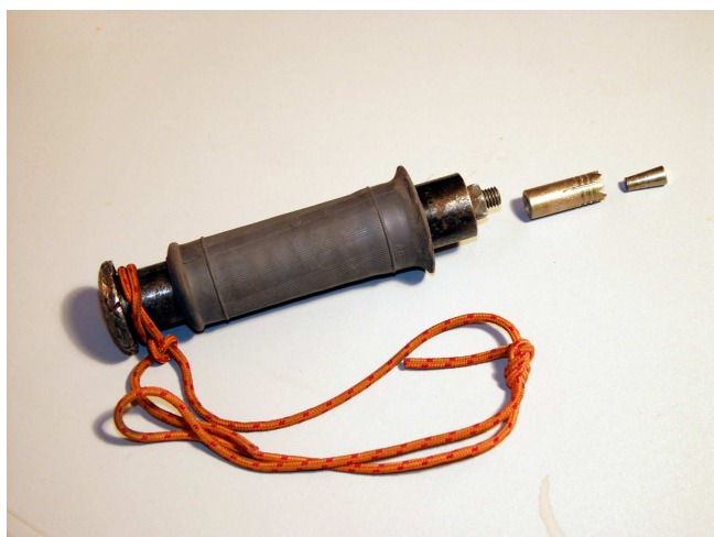
C'est ce genre de tamponnoir qui était utilisé pour faire le trou dans lequel était ensuite enfoncé le piton golot. Les pitons golots ou spits sont des pitons à expansion qui s'écartent dans le rocher.
